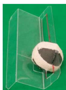
a. 直径30mm, 重さ50gの球体 b. ガイドを装着した直径30mm, 重さ50gの球体
