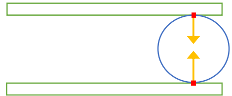
図12 直径15mmの球体を箸でつまむ際の力学的関係
