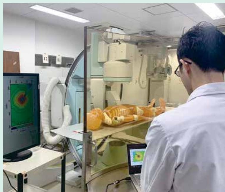
IVR装置使用時の散乱線測定実験
